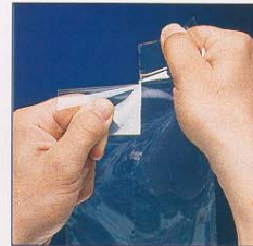
Les films de sécurité standard sont très faciles à déchirer. Les nouveaux films sécurité haute performance 3M, grâce à la multitude de couches qui les composent, sont étonnamment durs comme le démontre leur excellente résistance à la déchirure.
