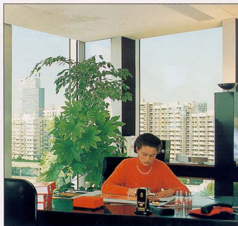
Le film sécurité haute performance teinté gris, outre ses qualités de sécurité, possède également des propriétés de contrôle solaire, contribuant ainsi à rendre l'atmosphère du local plus tempérée.
