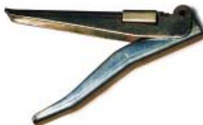
La pince à replier forme la boucle nécessaire et évite les amorces de rupture qui peuvent se former lors d'un mauvais pliage du feuillard au marteau.
