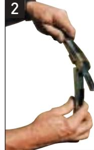
**3.** Engager la chape sur le feuillard, ergots en avant, jusqu'à ce qu'elle bute dans le fond de la boucle. Ceinturer le support et engager l'extrémité libre dans la chape.
