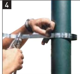
**5.** Mise en tension du feuillard. Maintenir l'appareil par son levier de cisaillement (bras le plus court) et actionner alternativement le levier de tension (bras le plus long) d'arrière en avant jusqu'à la tension maximum.
