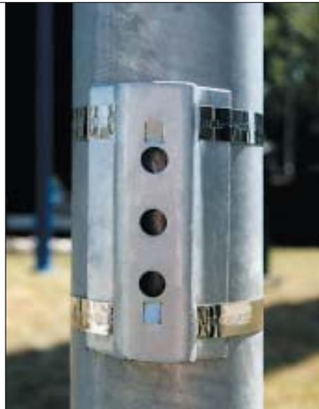
Cette pièce a été conçue pour fixer des consoles en tube normalisé de Ø 34, 42, 49, à l'aide de deux cerclages double tours. Un étrier et deux contre-écrous (fournis avec la pièce) assurent le blocage de la console dans la position désirée.
