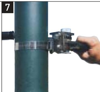
**8.** En maintenant l'appareil par le levier de tension, pousser vers l'avant le levier de cisaillement jusqu'à coupe du feuillard. Rabattre la languette sectionnée sur la chape avec le pouce
