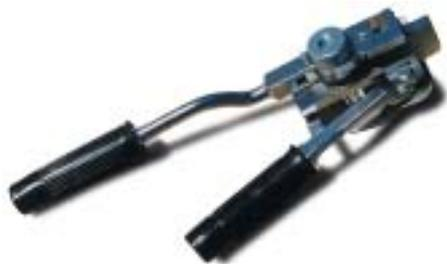
L'appareil à cerler assure une tension parfaite, coupe le feuillard en fin d'opération
