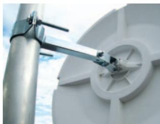
Livrée avec chaque miroir, fixation universelle pour murs et poteaux de 34 à 90 mm de section. Permet un réglage très précis de la position du miroir. Testée pour résister au vent jusqu'à 183 km/h.
