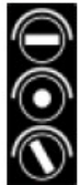
R18 Signaux directionnels pour véhicules des services réguliers de transport en commun
