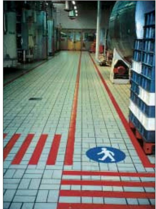
Photo 4.1 Allées de circulation intérieure balisées et identifiées ; les sols carrelés facilitent l'entretien.
