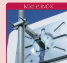
Livrée avec chaque miroir inox, fixation universelle en acier galvanisé pour murs et poteaux ronds (Ø 76 à 90 mm) ou rectangulaires (60x80 ou 80x80 mm). **A installer sur poteaux en acier exclusivement.**
