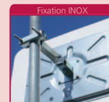
Livrée avec chaque miroir inox, fixation universelle pour murs et poteaux ronds (Ø 76 à 90 mm) ou rectangulaires (60x80 ou 80x80 mm). **A installer sur poteaux en acier exclusivement.**
